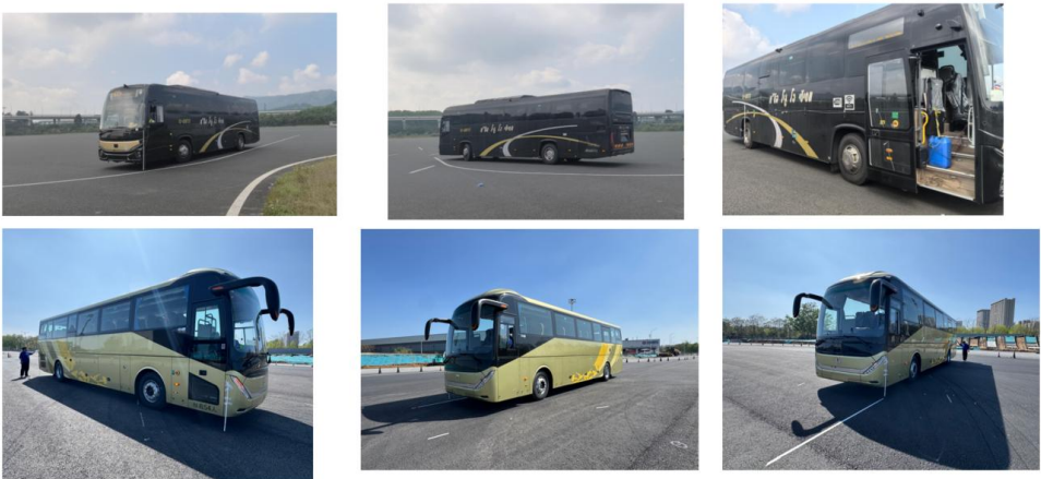
图 8 车长 12m 级别营运客车转弯通道最大宽度试验
