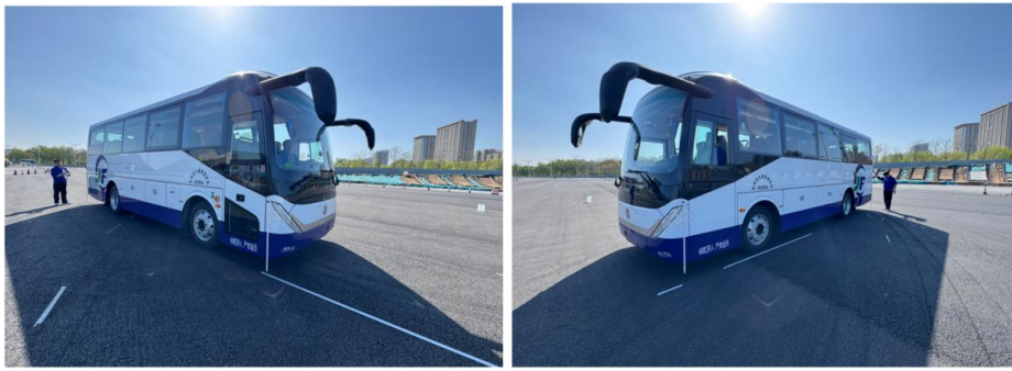
图9 车长9m级别营运客车转弯通道最大宽度试验
