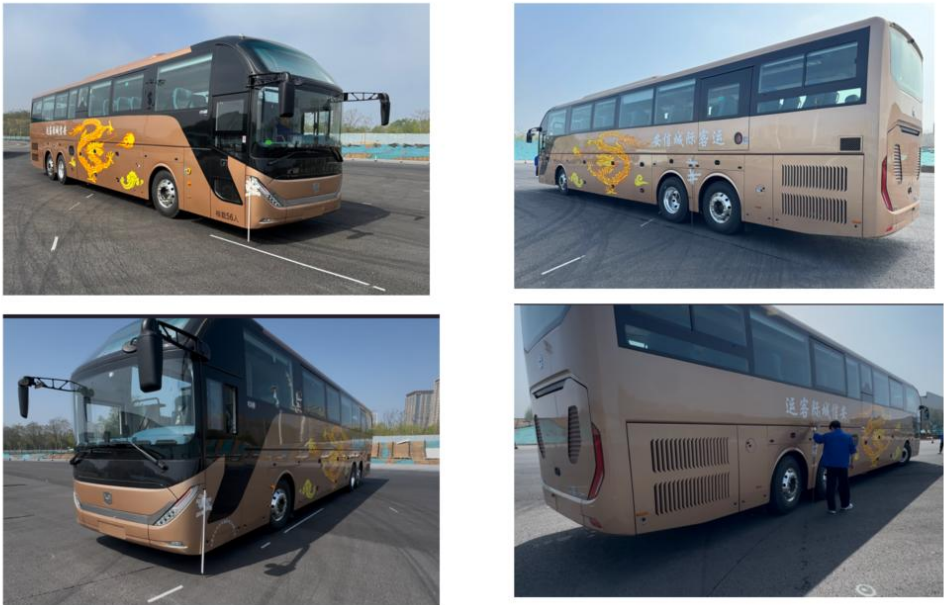
图 7 车长 13m 级别三轴营运客车转弯通道最大宽度试验
